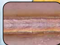
Soudure à l'arc court obtenue sous gaz de protection Stargon SS
