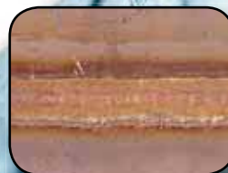
Soudure à l'arc court obtenue à l'aide d'un mélange à teneur élevée en hélium
